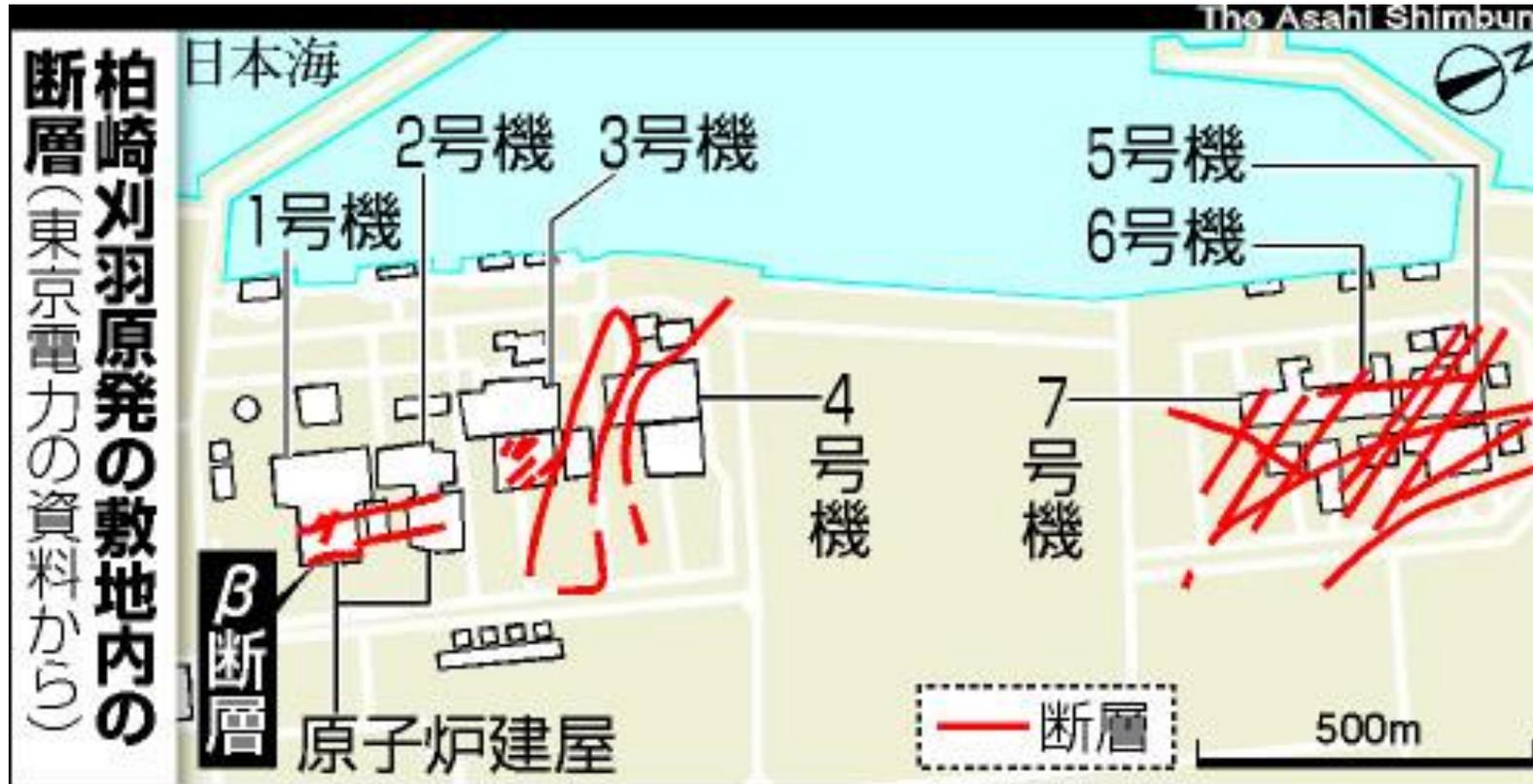
・特重施設建設にあたってのボーリング調査で、新たに15条の断層を確認したと東電は発表した。核物質防護の観点で詳細なデータは公表されていない。
